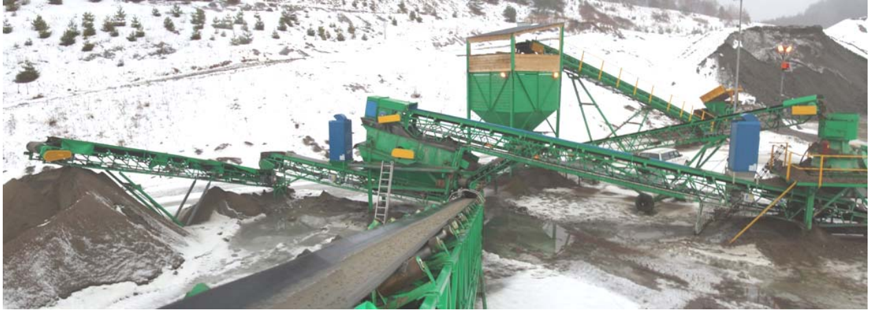
Figur 3. Jehanders krossanläggning för halkstopp i Fjärås där försöken med algoritm för val av spalt utfördes.
